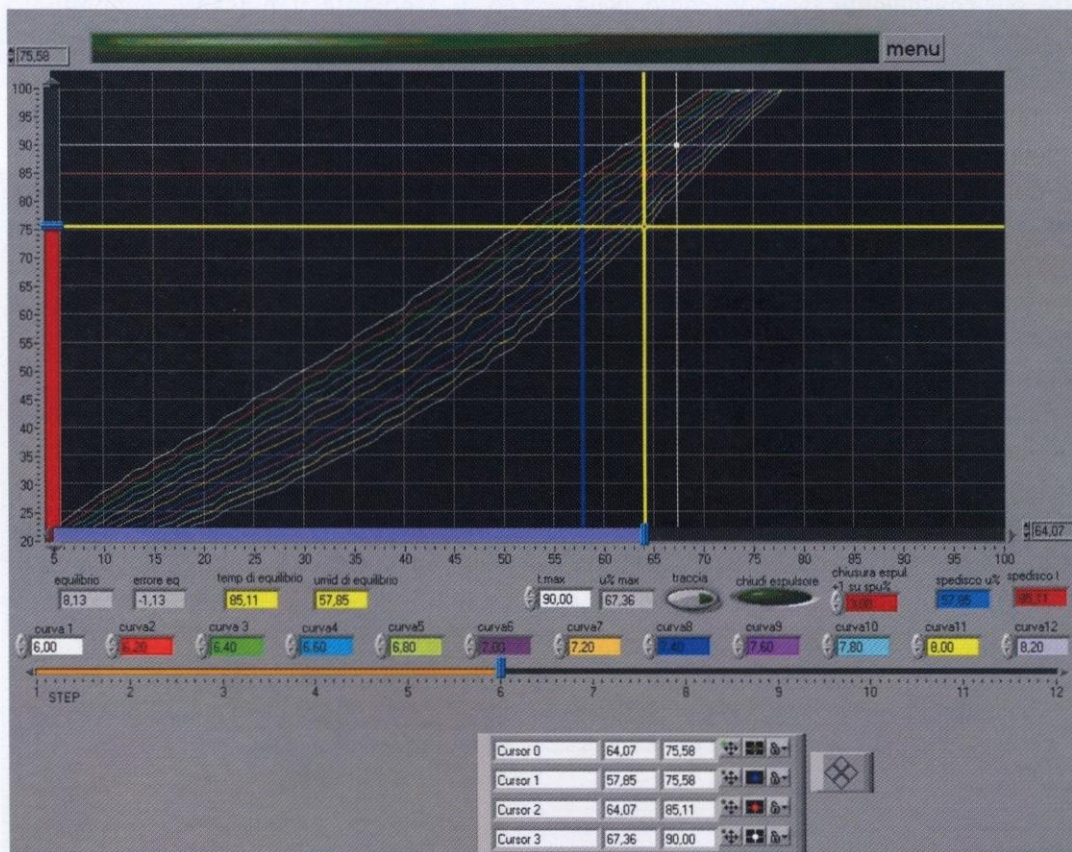
Rappresentazione grafica di alcune curve d'equilibrio per i diversi step di una cella statica (in ascissa l'umidità di processo, in ordinata la temperatura di processo).
